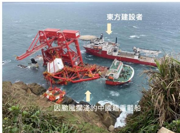
2024 年 11 月 7 日，東方風能接獲交通部航港局的緊急徵召，協助處理一艘因颱風擱淺於新北市野柳岬的重載貨輪，該船裝有 250 噸重油，一旦油料洩漏將造成國家生態系統遭受汙染破壞。東方風能在接獲通知後，立刻調派東方建設者前往事故地點，且於 11 月 8 日迅速抵達展開施工準備，於惡劣的海象條件下完成油料抽除設備的海上吊掛及轉移，使得後續的殘油移除作業得以順利進行，避免海上油汙染風險進一步擴大。
